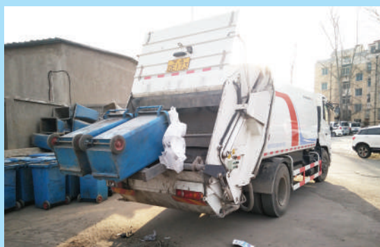
垃圾中转直接压缩上车
